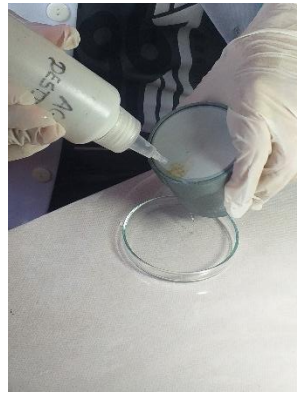
Figura 32. Traspaso de los residuos retenidos en el tamiz a una caja Petri.
