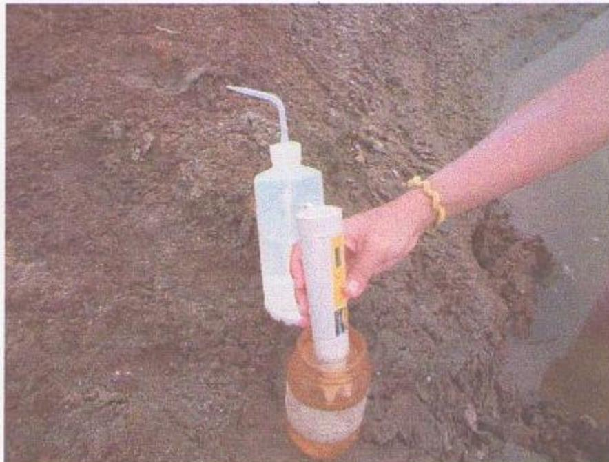
**Anexo # 5.** Parámetros abióticos: Medición de salinidad junto a la toma de la muestra. Utilizando un refractómetro de mano marca ATAGO, Modelo 5/Mill
