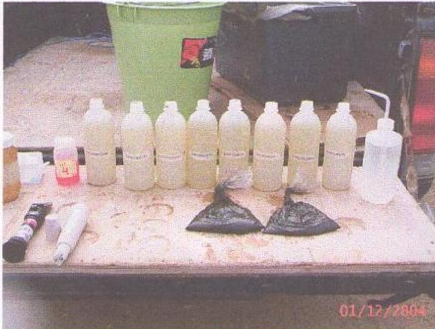
**Anexo # 4. Parámetros abióticos: Medición de pH junto a la toma de la muestra. Utilizando un equipo de mano pH testr2 "double junction" (OAKTON® Instruments)**
