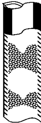
Figura 12: Se muestra como es el flujo tapón dentro de la tubería vertical.
