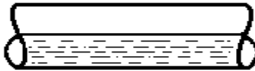
Figura 8: Se muestra como es el flujo estratificado dentro de la tubería horizontal.
