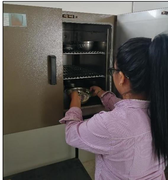
*Nota:* Elaboración de los ensayos para la determinación del contenido de humedad de los agregados.
