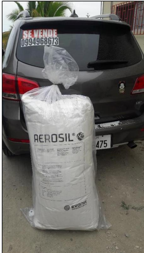
*Nota:* Muestra del aditivo Aerosil® 200 antes de ser usado en los diferentes diseños de mezclas de hormigón.
