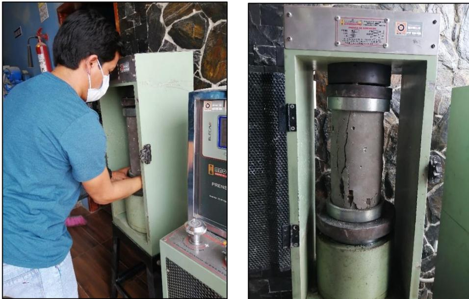
Nota: Roturas de cilindros sometidos a presión, ensayos de compresión.
