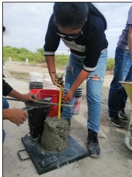
*Nota:* Ensayo del asentamiento de la mezcla de hormigón por medio del cono de Abrams.
