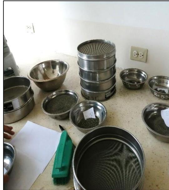
*Nota:* Elaboración de los ensayos de granulometría a los agregados gruesos y finos.
