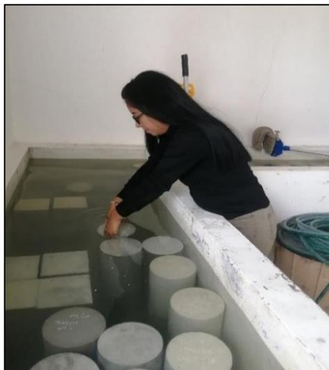
*Nota:* Colocación de las probetas de hormigón en las piscinas de curado.
