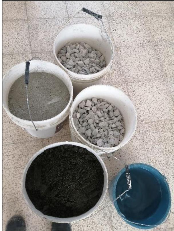
*Nota:* Cantidad de agregados para una mezcla determinada de hormigón.
