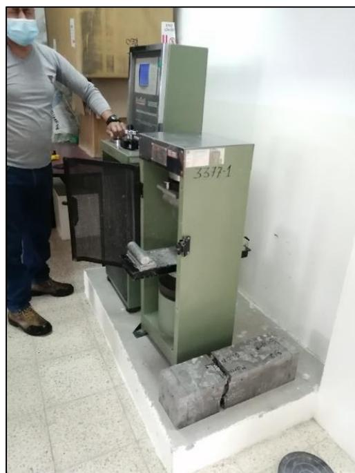
*Nota:* Ensayos a flexión de vigas.
