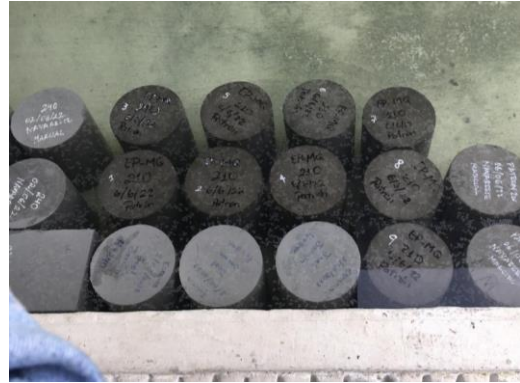
Cilindros en piscina de curado
