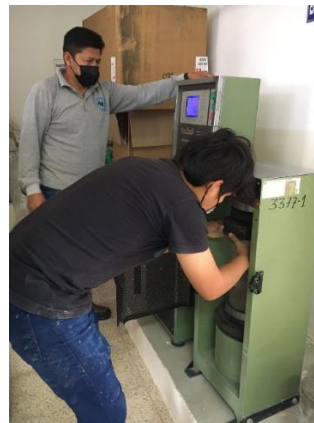
Colocación de cilindro para ensayo a compresión
