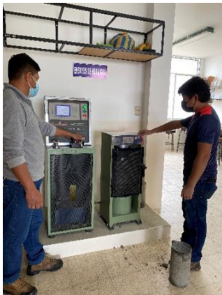
Figura 20 Prensa hidráulica para ensayo de resistencia a compresión
