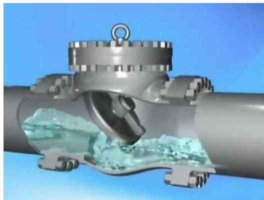
Figura 6. Válvula Check. Tomado de [larocamadrehg.blogspot.com](http://larocamadrehg.blogspot.com), 2021.
