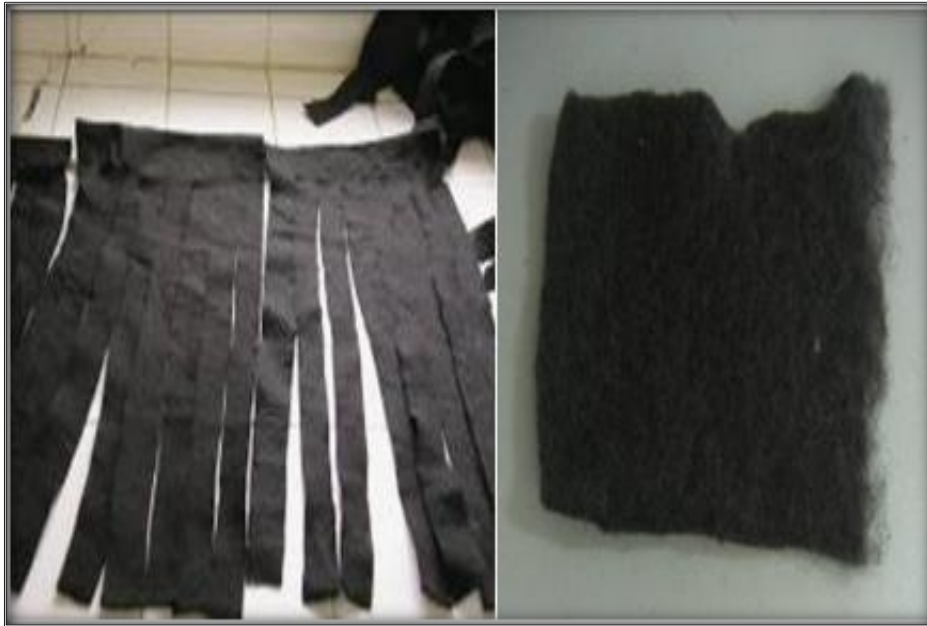
Fig. 7. Sustrato empleado: Geotextil - fibras de polipropileno
