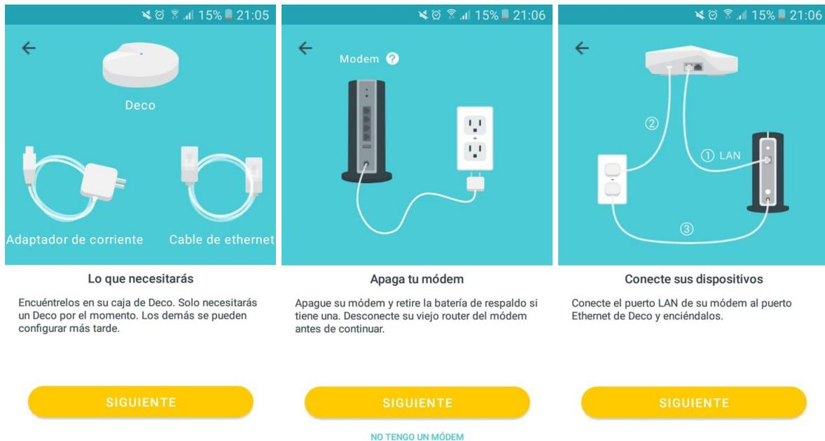
Fig. 49 Conexión de los equipos MESH al router principal
