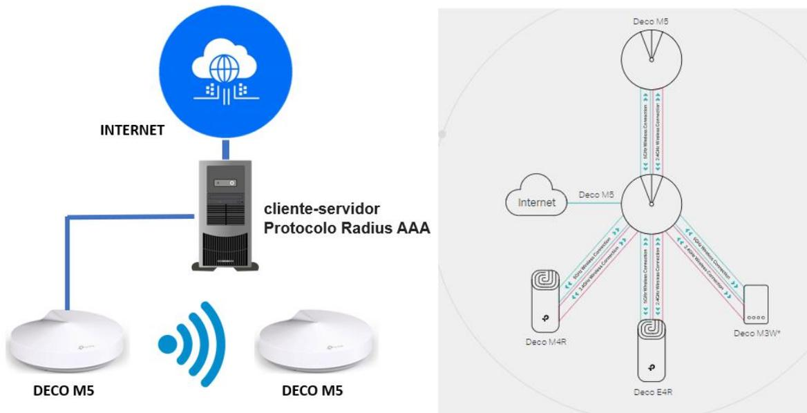
Fig. 30 Arquitectura de la nueva red con servidor Radius.
