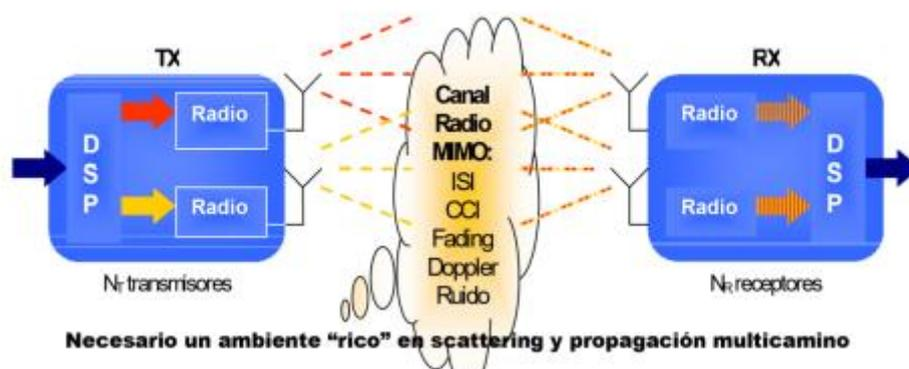
Fig. 2 Esquema general de operación de un sistema MIMO [25]
