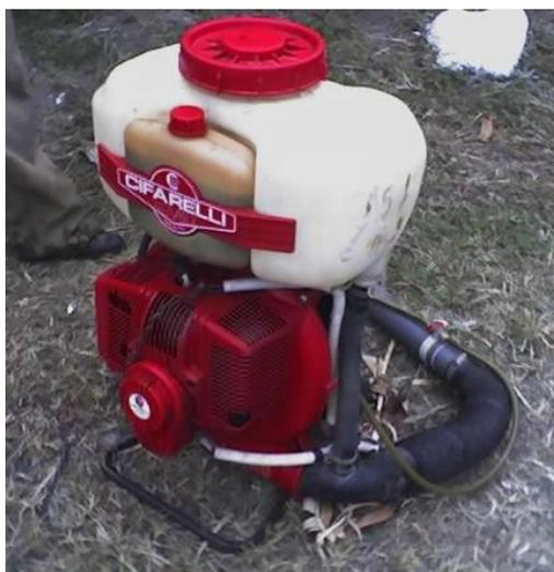
**Figura 16. Motobomba nebulizador de 20 litros**
