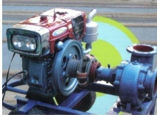
**Figura 14. Bomba de caudal de 3" 25 hp 2 200 r.p.m profundidad 6 a 8 m**
