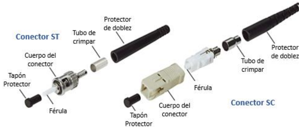
Figura 3.13. Esquema de un conector óptico ST y SC.
