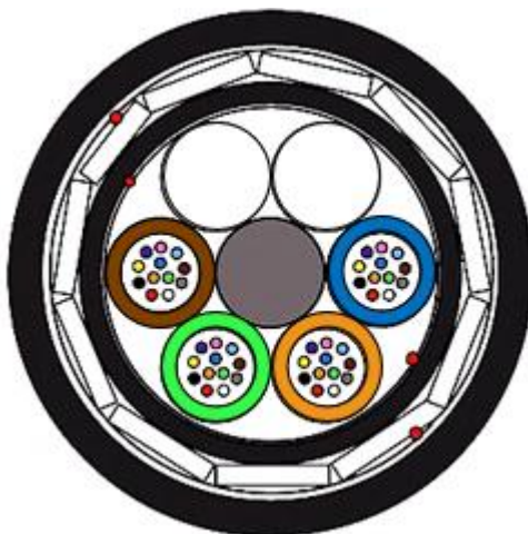
Figura 4.11. Esquema de colores del cable de fibra de 48 hilos (norma TIA-598-C).
