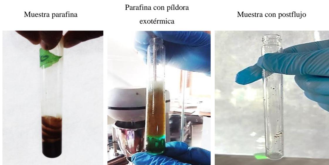
**Figura 25.** Análisis de resultados Ensayo de dispersión de parafina.
