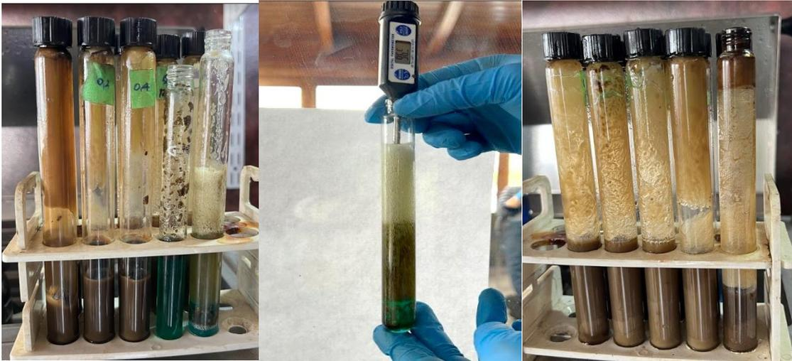
**Figura 12.** Resultados Ensayo de dispersión de parafina.
