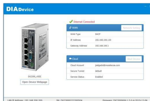
Figura 35. Configuración de Router en DIADevice
