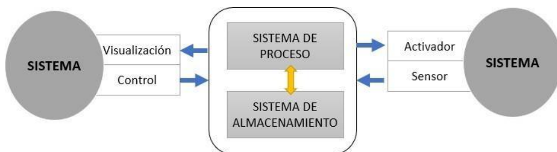
Figura 7. Estructura del nivel de supervisión
