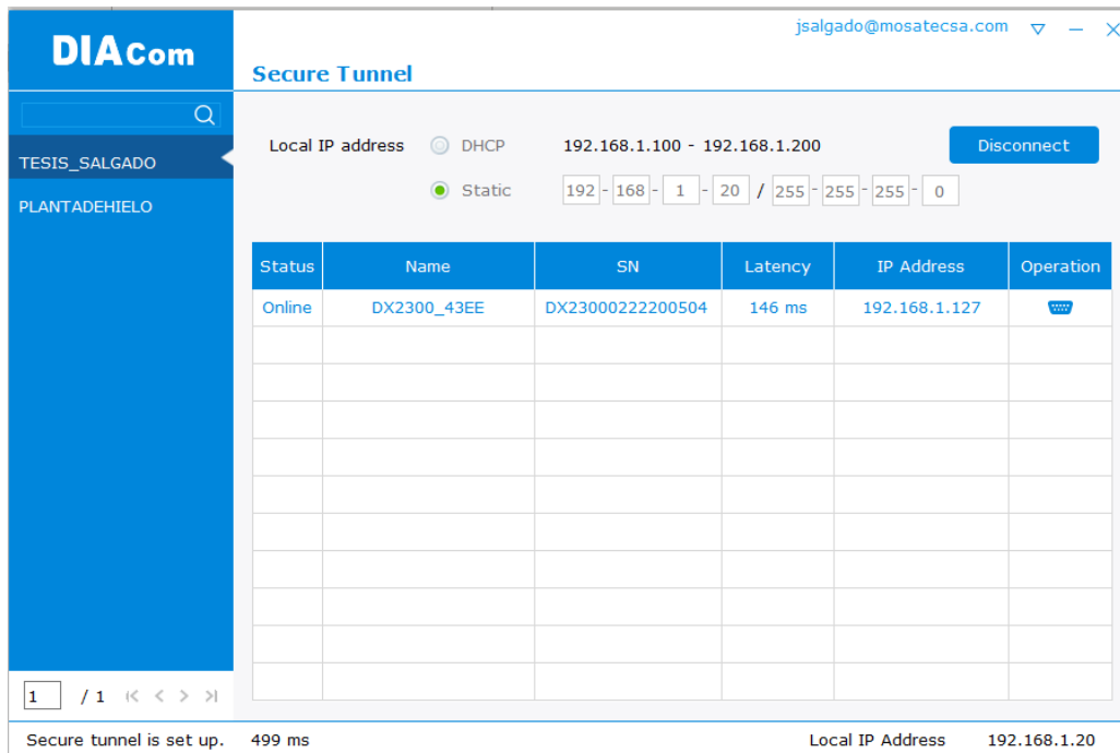
Figura 39. Creación del túnel seguro.
