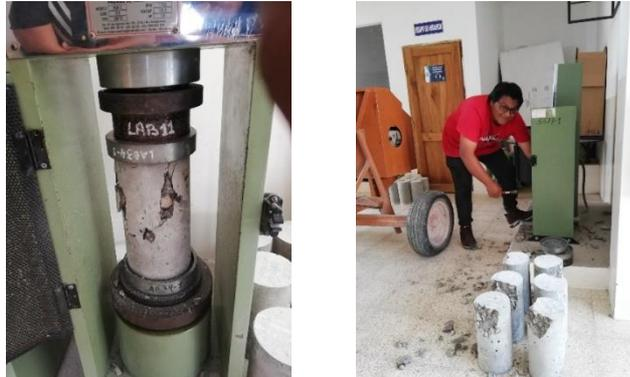
En la Figura 17 se muestran los resultados obtenidos que nos da el equipo de ensayo a compresión y además se observan como quedan los cilindros después del ensayo.
