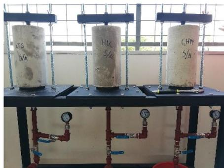
En la Figura 20 se muestra el bombeo hidráulico manual que se le da al equipo para que este alcance la presión indicada por la Norma Española UNE-EN 12390-8 (2019).
