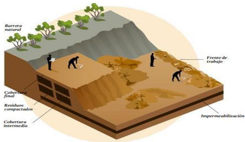
Figura 5 Relleno sanitario Manual
