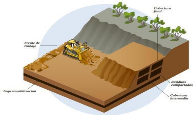
Figura 3 Relleno sanitario mecanizado
