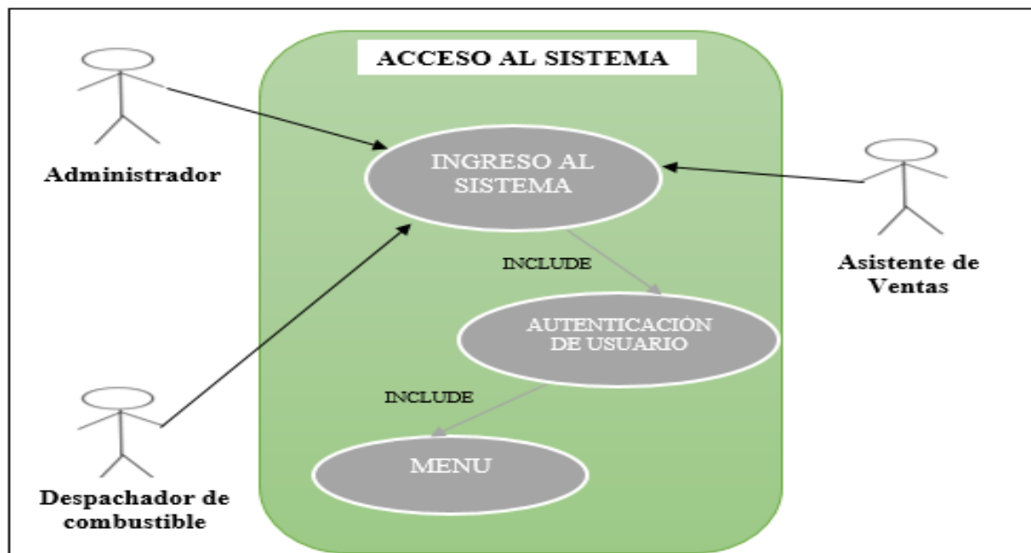
Ilustración 6 Diagrama de caso de uso de acceso al sistema.
