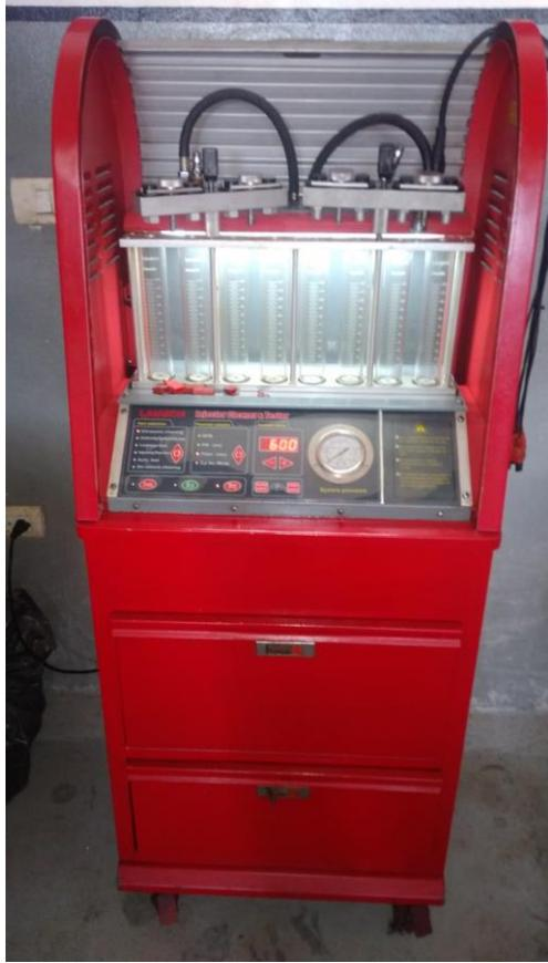
*Máquina / Diagnostico y prueba de inyectores*
