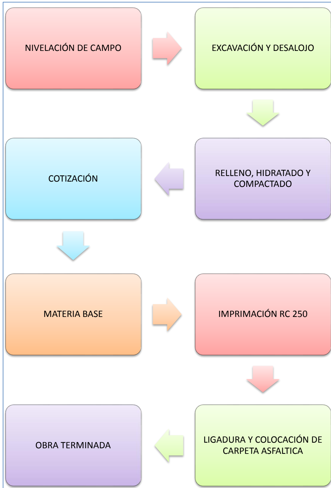
GRÁFICO N° 33: Proceso de Obra Construcción de Carpeta Asfáltica
