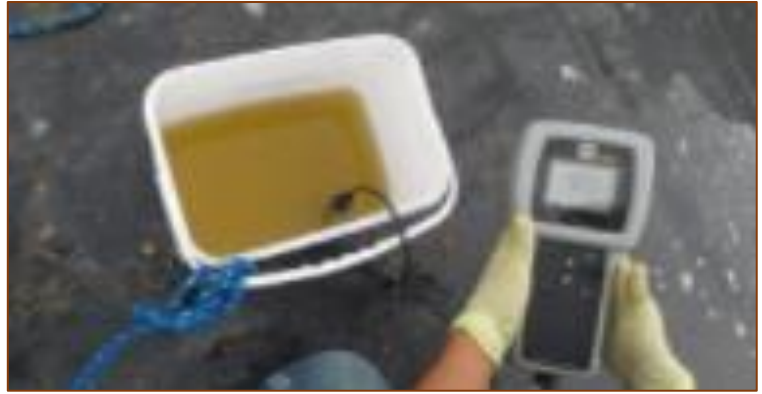
Nota: 10.- Medición de oxígeno y temperatura.
