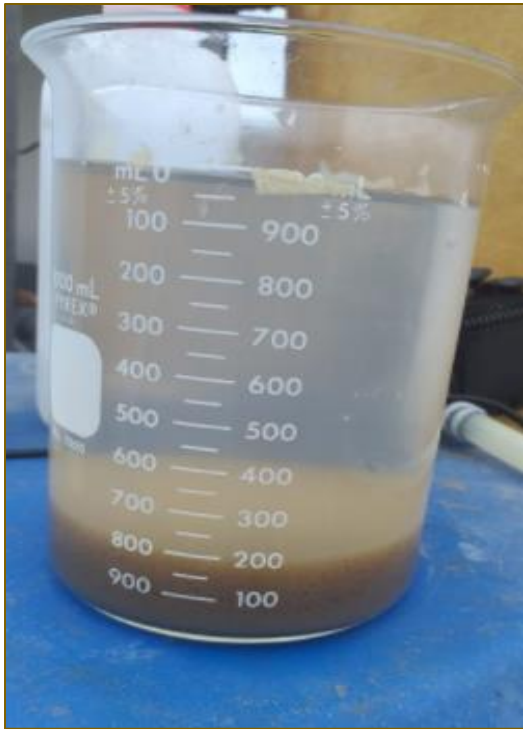
Nota: 6.- Se observa el 30% de lodo activado vs el 70% de agua a tratar.
