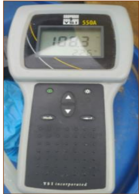
Nota: 13.- Multiparámetro, medición de oxígeno disuelto y temperatura.
