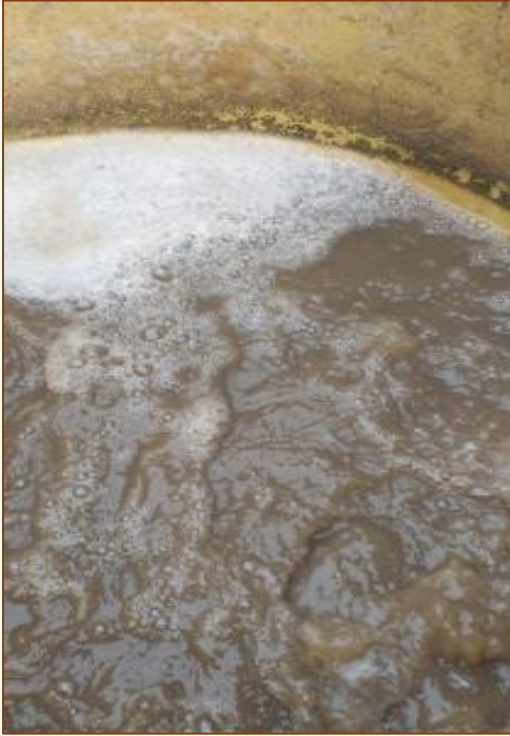
Nota: 22.- Lodo activado color marrón en proceso de tratamiento de agua.
