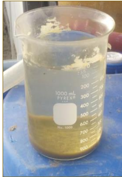
Nota: 7.- Decantación del lodo, lodo compactado, marrón y macrofloculos bien formados después del tiempo de decantación
