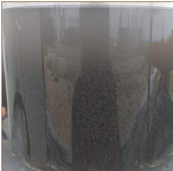
Nota: 26.- Visibilidad del inicio del tratamiento para la formación ideal del lodo activado.
