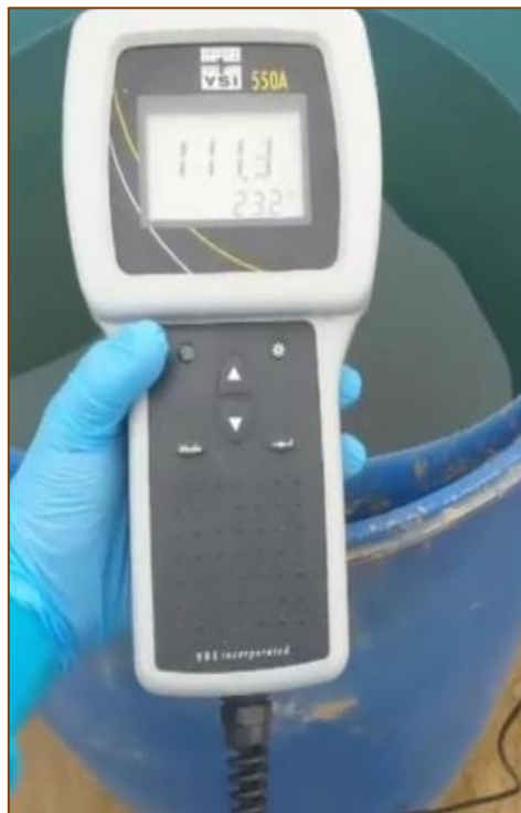
Nota: 24.- Medición de oxígeno disuelto y temperatura en la salida de agua, después del tratamiento.
