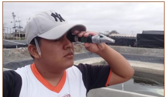
Nota: 16.- Refractómetro, medición de la salinidad.
