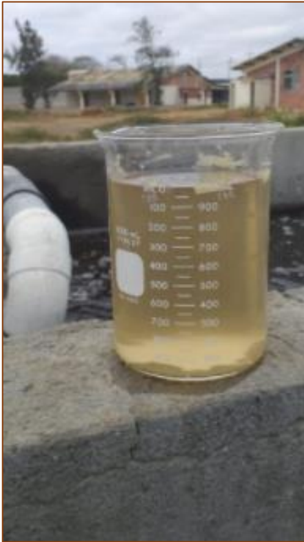
Nota: 9.- Entrada de agua, antes del tratamiento.
