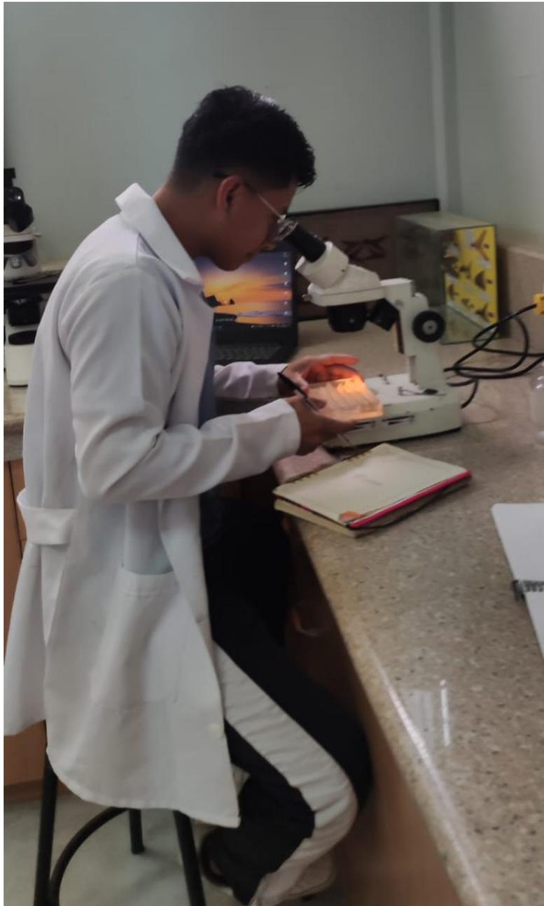
**Foto 8:** Conteo de organismo mediante el uso del estereoscopio y cámara de bogorov
