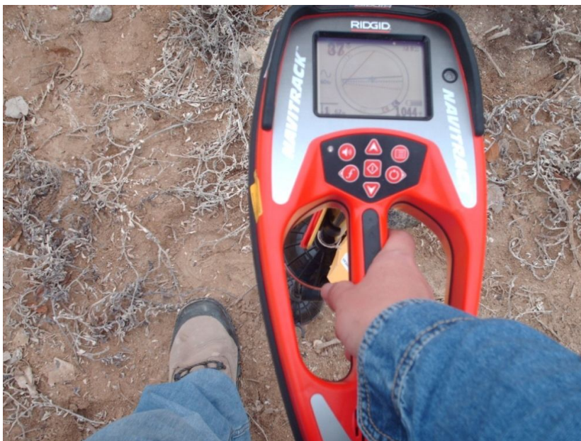
FIGURA 3.9: LOCALIZACION DE LINEAS EXTRANGERAS EN SECTOR DE MONTEVERDE
