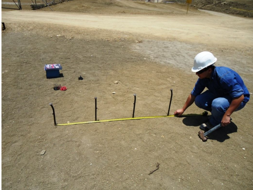
FIGURA 3.7: MEDICION DE RESISTIVIDAD DEL SUELO EN EL SECTOR MONTEVERDE
