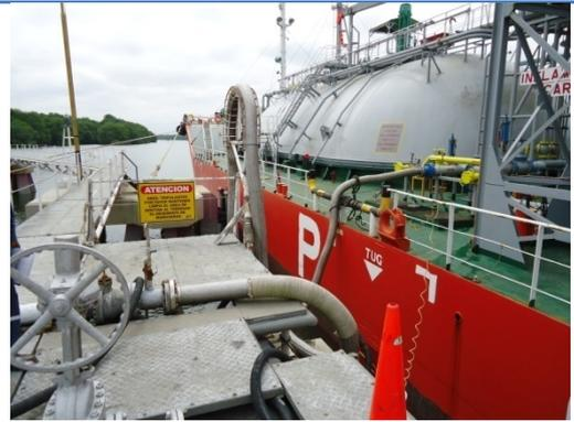
Fotografía 27: Conexión segura del B/G
