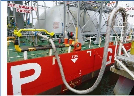
Fotografía 26: Conexión de manguera del B/G contenedor de GLP
