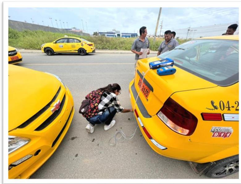
*Figura 80 Colocar la sonda en el tubo de escape*
