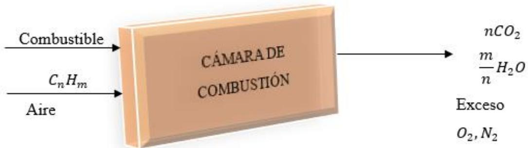
Figura 3. Proceso de combustión completa
