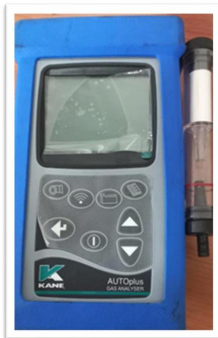
*Figura 78 Analizador de Gases de escape portátil*
