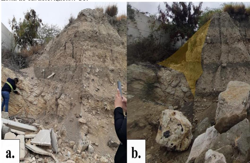
Es visible la zona de contacto entre suelos residuales y la matriz rocosa correspondiente al miembro Santa Elena de características geotécnicas similares a las caracterizaciones 2 y 3 detalladas posteriormente, así como el transporte de materiales por acción de lluvias. Acorde a los ensayos realizados la estratigrafía de la caracterización C1 se detalla en la **tabla 12** y **figura 20**.
