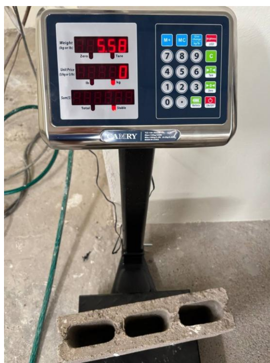
Figura. Pesaje promedio del bloque de hormigón.
