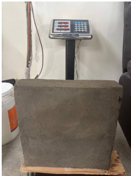
Figura. Pesaje unidad de murete.
