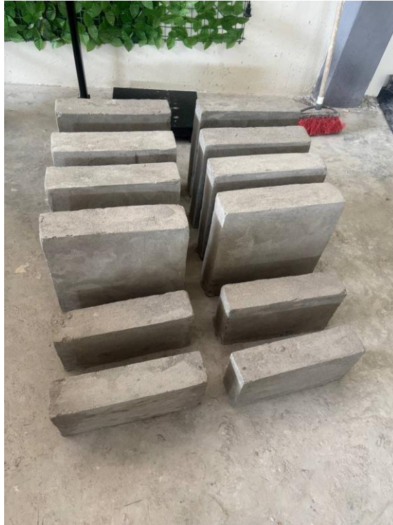
Figura. Curado de muretes.
