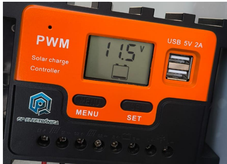
Figura 39: Configuración para protección de la batería
