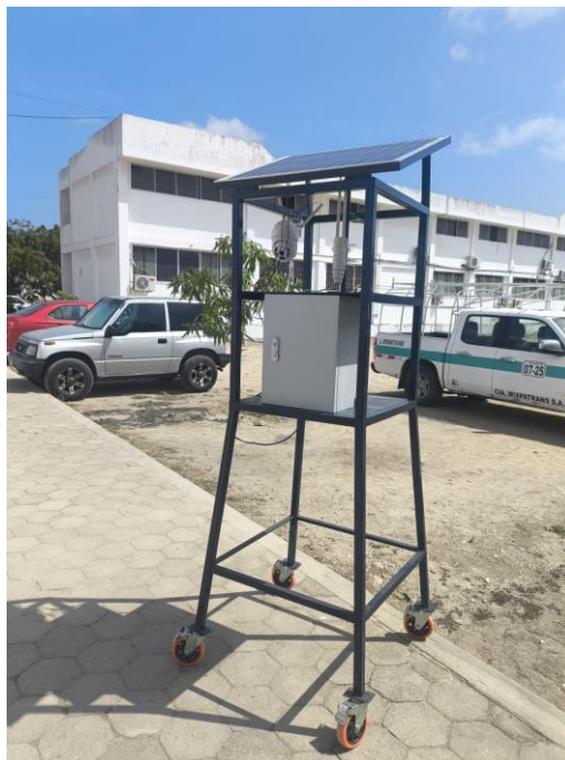
Figura 28: Prototipo de red inalámbrica alimentado por energía solar
