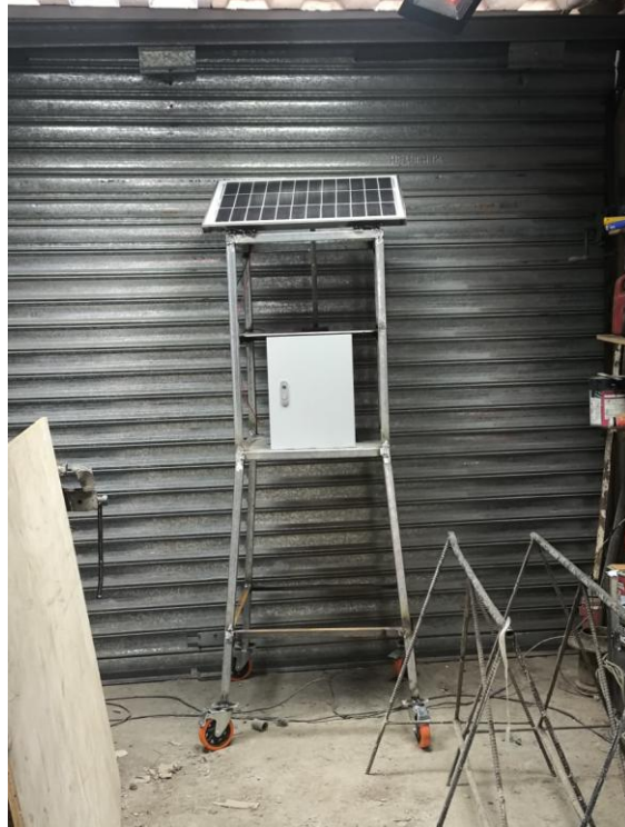
Figura 31: Armado de la estructura portátil
