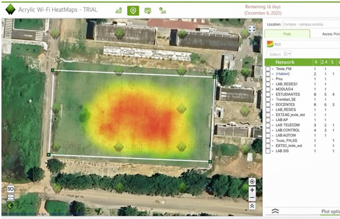
Figura 48: Ejemplo de mapa e calor simulado de cobertura en 2.4 GHz en la cancha natural
