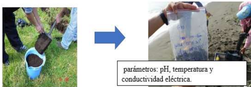
Figura 5. Procedimiento para la toma de muestra de suelo para ser analizado en laboratorio.
