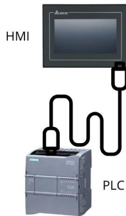
Figura 4. Conectividad entre PLC y HMI.
