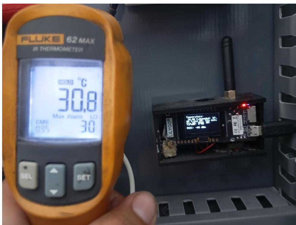
Figura 32. Prueba de validación de valores medidos por el sensor.
