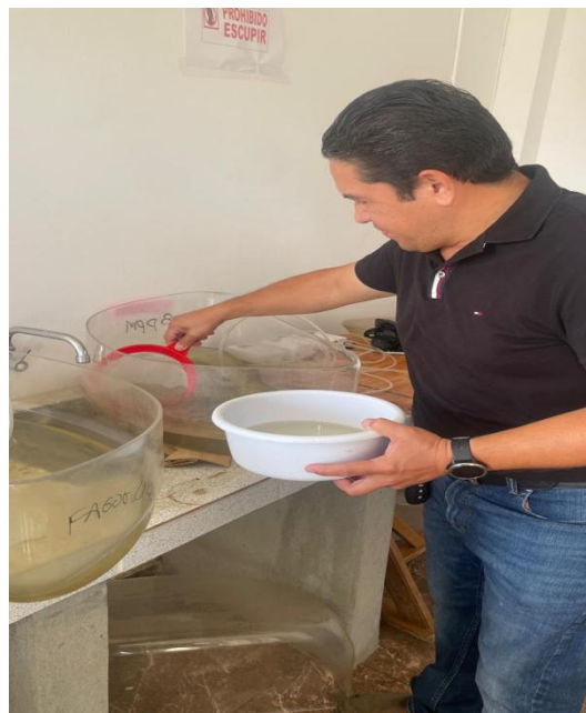
Fotografía 4: Recogida de muestra para análisis MIC
