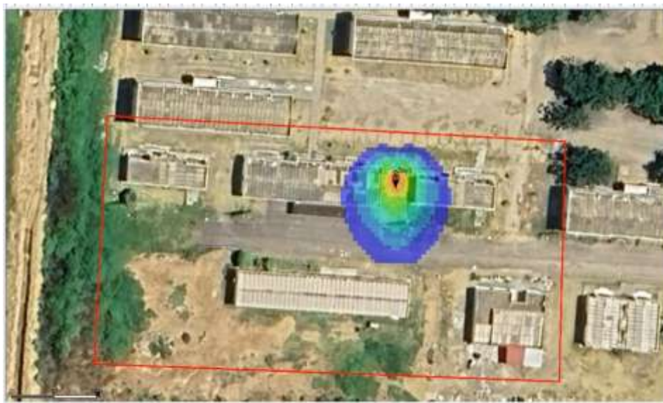
Figura 40. Área de cobertura del amplificador (antena interior)
