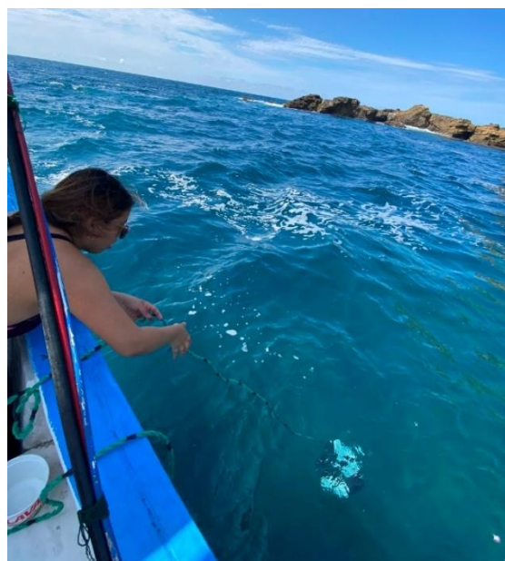
Figura 17. Medición de turbidez con disco secchi
