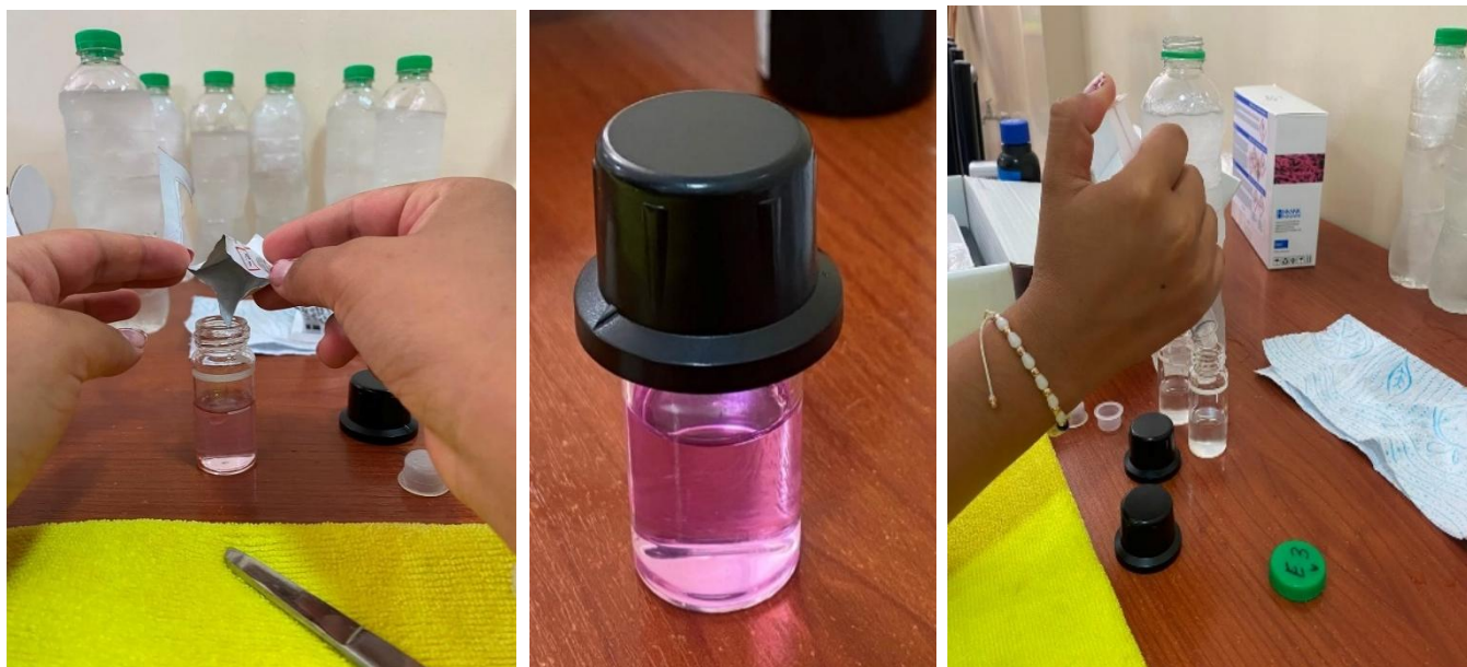
Figura 26. Análisis de agua de las diferentes estaciones del área de muestreo con el fotómetro de Hanna y sus reactivos
