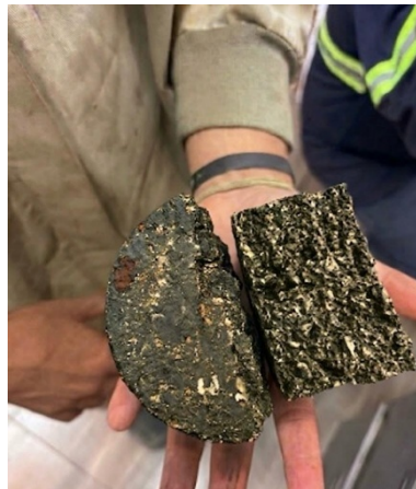
Briqueta de emulsión asfáltica después de ensayo TSR
