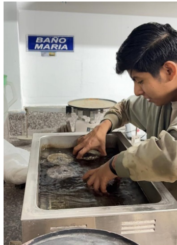
Regulación de temperatura en baño María
