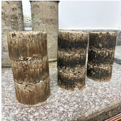
Desencofrado de las briquetas
