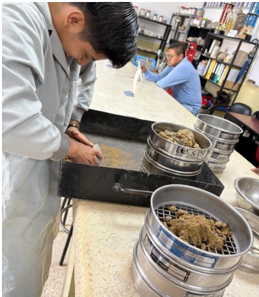
Ensayo de Granulometría material de cantera Juan Montalvo
