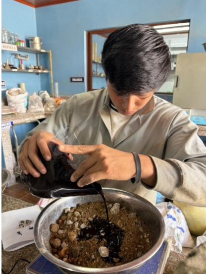
Dosificación de emulsión asfáltica en suelo previamente humedecido
