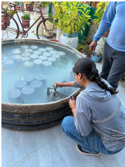
Toma de lecturas de hinchamiento de muestras sumergidas CBR
