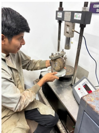
Ensayo a Tracción indirecta a briquetas con estabilizante óptimo
