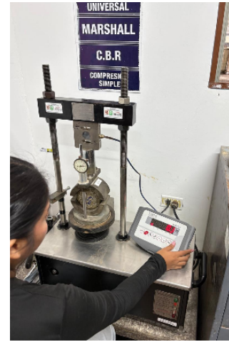
Rotura Marshall a briquetas con estabilizante óptimo
