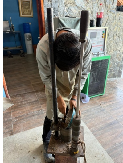
Compactación de las briquetas
