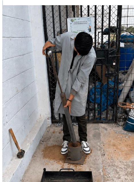
Ensayo Proctor modificado
