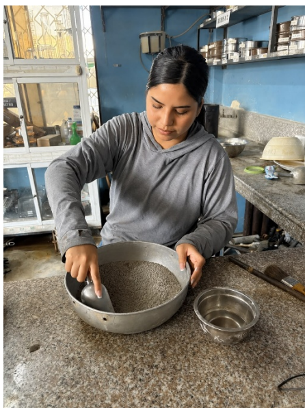
Preparación de mezcla con los diferentes porcentajes de cemento
