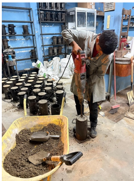
Proceso de compactación de la mezcla
