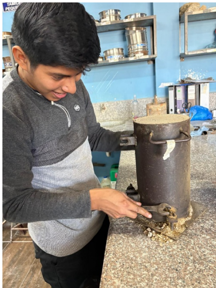
Desencofrado del espécimen
