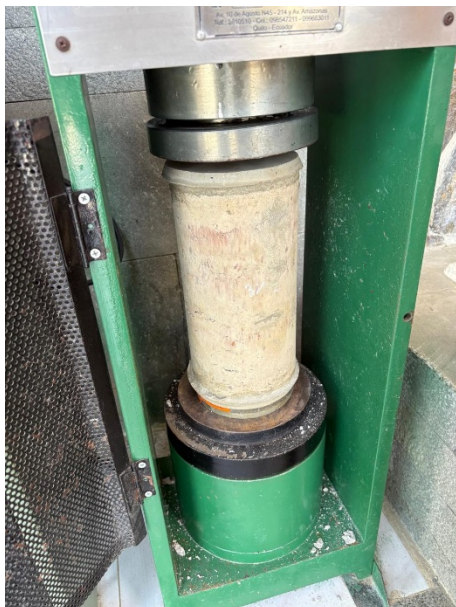
Preparación para Ensayo de compresión simple
