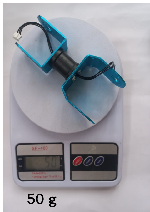
Figura Im1: Imágenes correspondientes al pesaje de las partes principales del brazo robótico utilizado en el presente proyecto.
