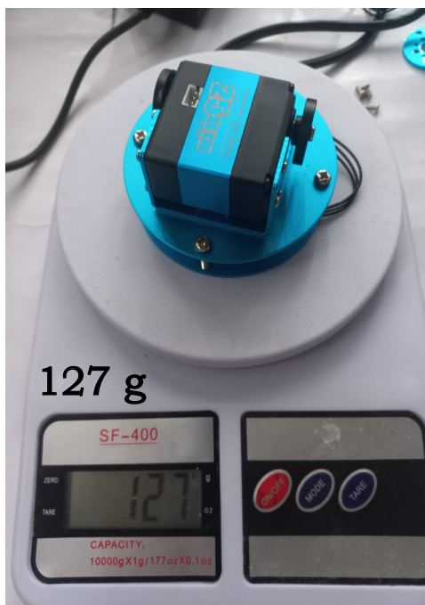
Figura Im1: Imágenes correspondientes al pesaje de las partes principales del brazo robótico utilizado en el presente proyecto.
