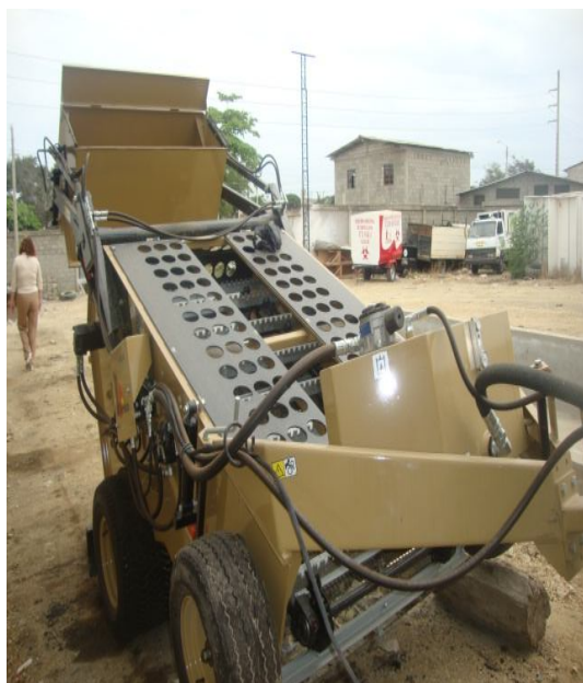
Máquina de Limpieza de playas Fuente: Tomado de los exteriores de las Oficinas de EMASA EP
