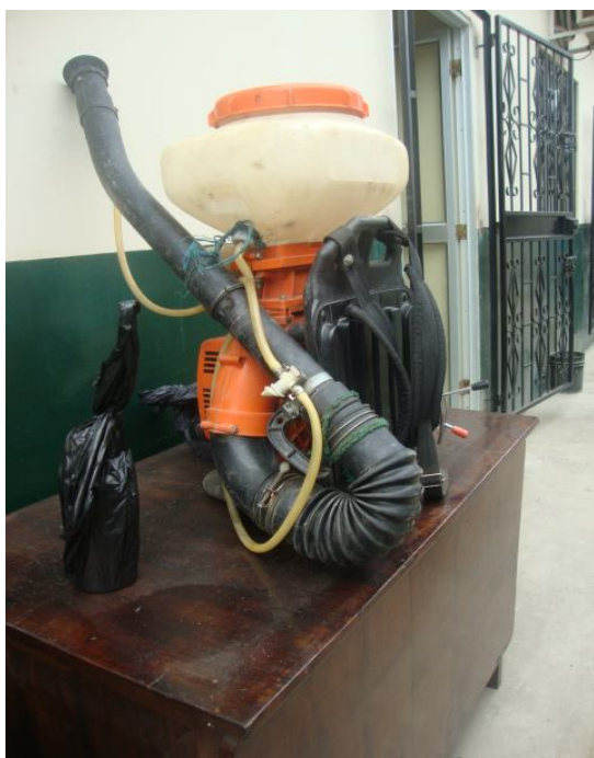
Bomba de fumigación Fuente: Tomado de los exteriores de las Oficinas de EMASA EP
