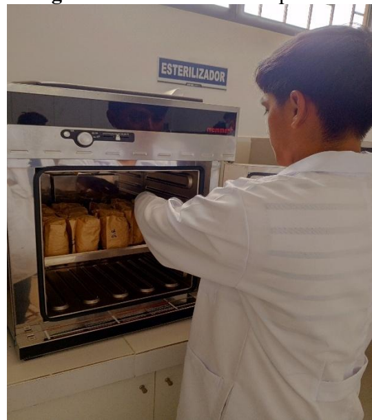
Figura 19A. Secado de semilla 200 g en estufa de circulación de aire a 75°C por 48 horas.
