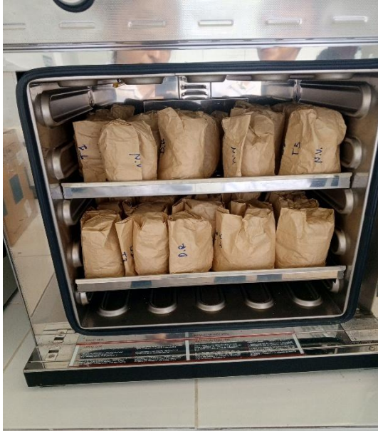
Figura 20A. Secado de 200 granos de semilla en estufa de circulación de aire a 75°C durante 24 horas.
