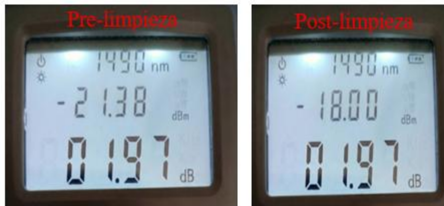
Figura 44 Medidas de Potencia en Submódulo Residencial
