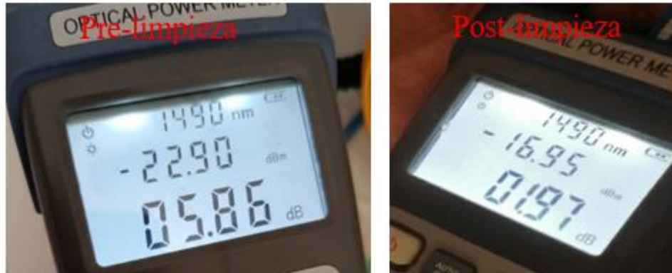
Figura 45 Estado Post-Limpieza del Submódulo Edificio GPON IX32
