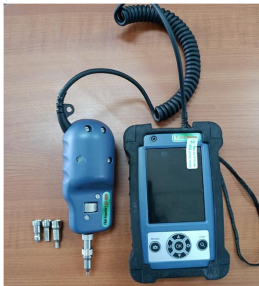
Figura 22 Microscopio de Inspección de fibra de aumento de 400X
