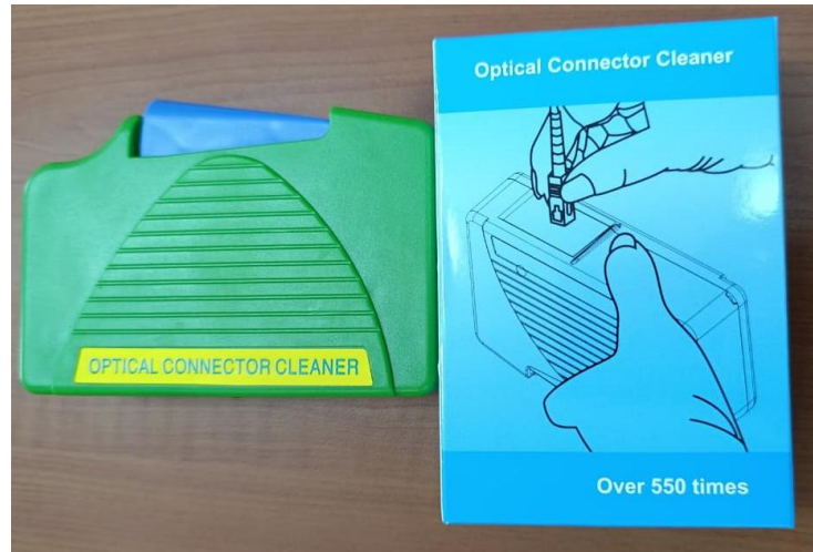
Figura 19 Casetes de Limpieza
