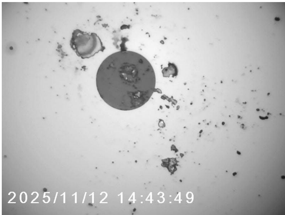
Figura 60 Conector tras soplado manual.
