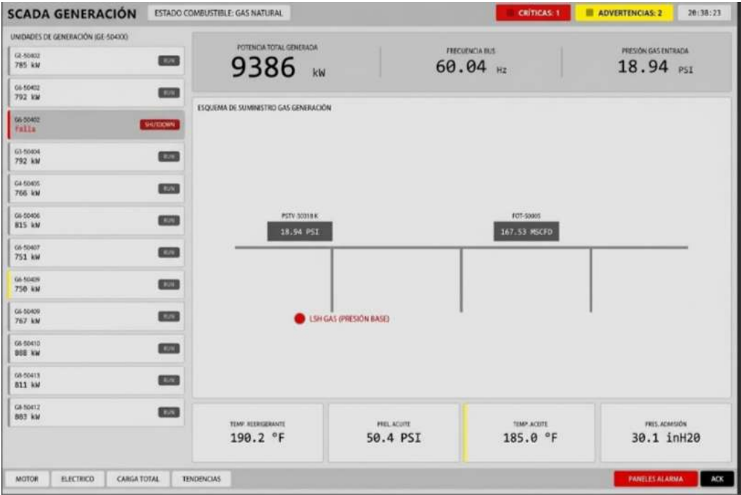
Figura 11 Interfaz HMI carga total generada
