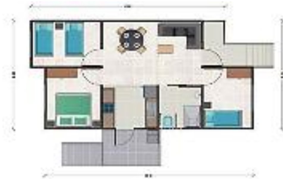
Figura 8. Planta arquitectónica vivienda Unifamiliar de 3 dormitorios
