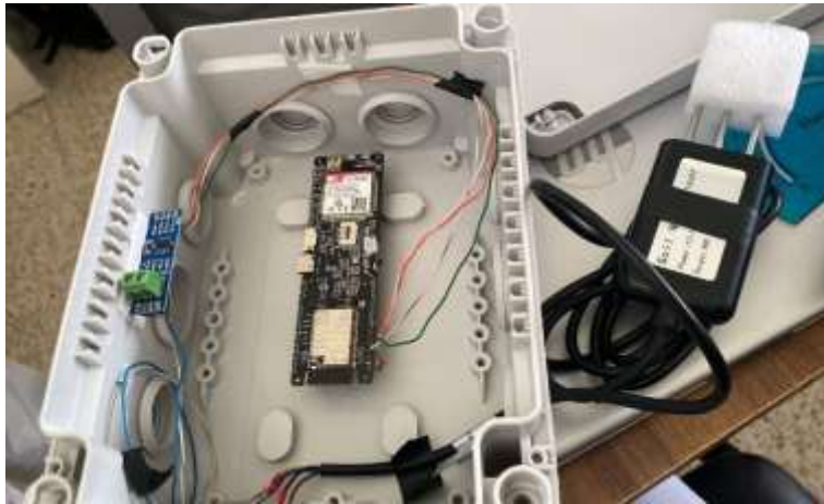
Anexo 4. Verificación del funcionamiento de la antena LTE-M/NB-IoT del nodo IoT.
