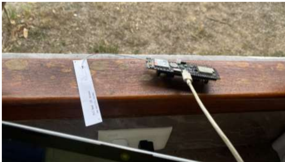
Anexo 4. Verificación del funcionamiento de la antena LTE-M/NB-IoT del nodo IoT.
