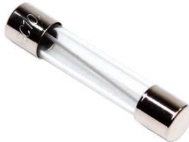
Figura 14. Fusible de vidrio de 2 A, 250 V y 20 mm empleado como elemento de protección del sistema de alimentación
