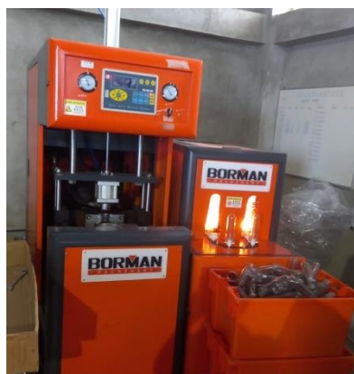
Anexo M: Maquina Sopladora de Preformas para botellas de 625 cc y 5 litros
