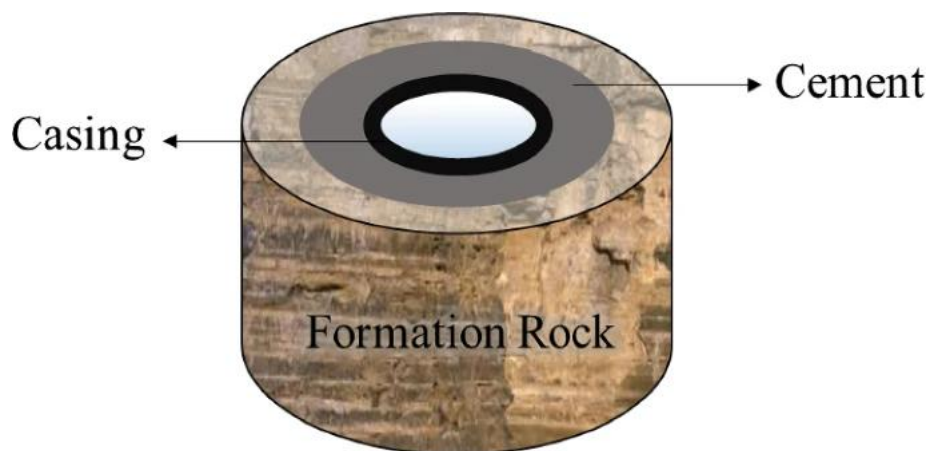
Figura 11. Diagrama esquemático del pozo en el contexto de la cementación, (Alkhamis & Imqam, 2021).
