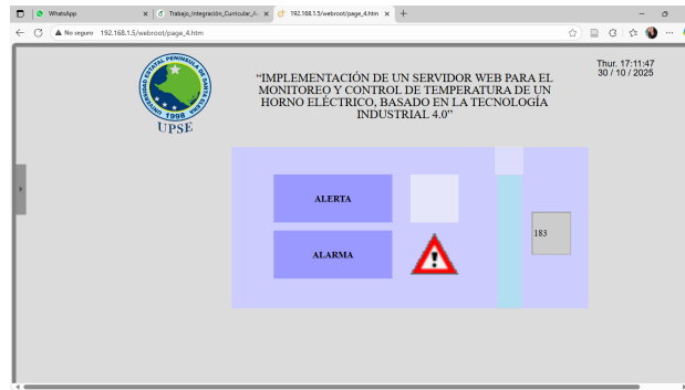
Figura 61: Prueba 3: Alarma activa-temperatura alta. Fuente: Autor.
