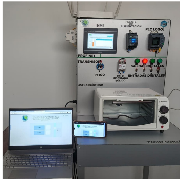
Figura 54: Prueba 2: Alarmas-HMI-Servidor. Fuente: Autor.
