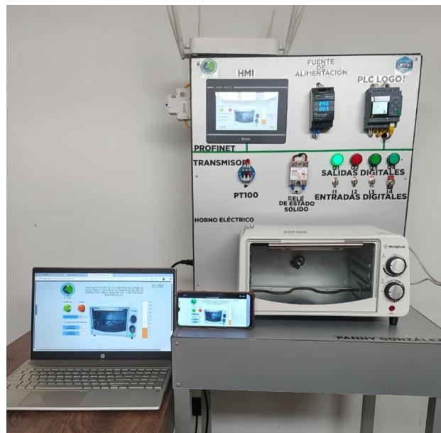
Figura 42: Prueba 1: Temperatura Baja. Fuente: Autor.
