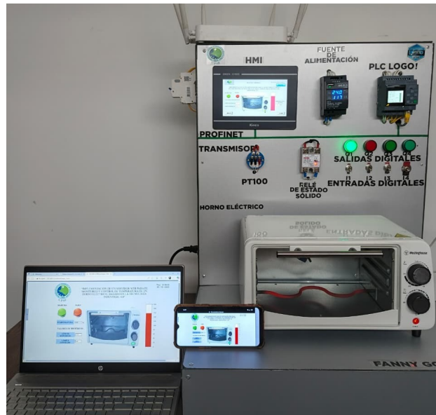
Figura 56: Prueba 3: Temperatura Alta. Fuente: Autor.
