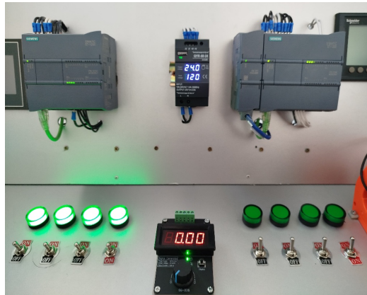
Figura 37: Prueba de comunicación industrial del PLC maestro - esclavo. Fuente: Orrala J. Malavé L (2025).
