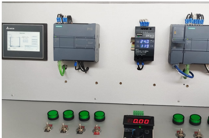
Figura 46: Prueba de comunicación industrial del protocolo RS-485 . Fuente: Orrala J. Malavé L (2025).
