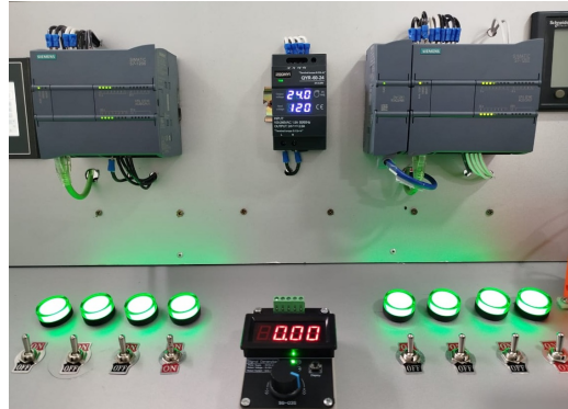
Figura 39: Prueba de comunicación industrial del protocolo Profinet. Fuente: Orrala J. Malavé L (2025).
