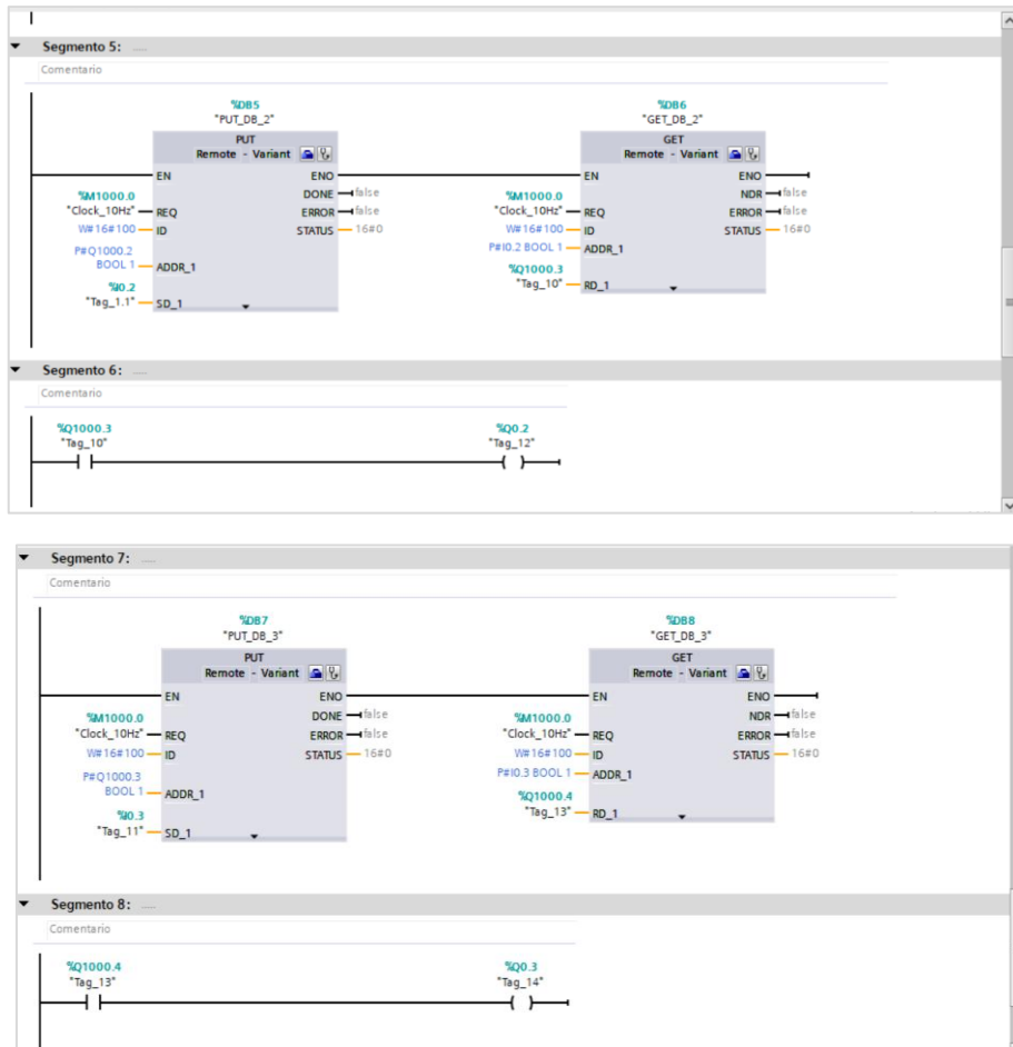
Fig. 9 Asignación de parámetros en los bloques
