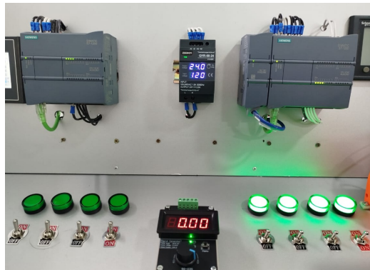
Figura 38: Prueba de comunicación industrial del PLC esclavo - maestro. Fuente: Orrala J. Malavé L (2025).
