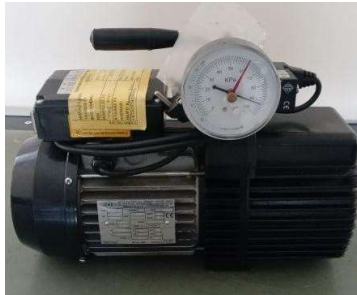
Bombas de vacío. La bomba de vacío es un equipo diseñado para extraer gases del interior de las tuberías del sistema de aire acondicionado.
