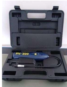
Detector de fugas. Detectar las vibraciones creadas en el aire por fugas minúsculas de gas o vapor bajo presión, y convertirlas en un silbido o alarma audible.
