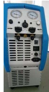
Recuperadora de gas refrigerante. Permite extraer el gas refrigerante de una instalación.
