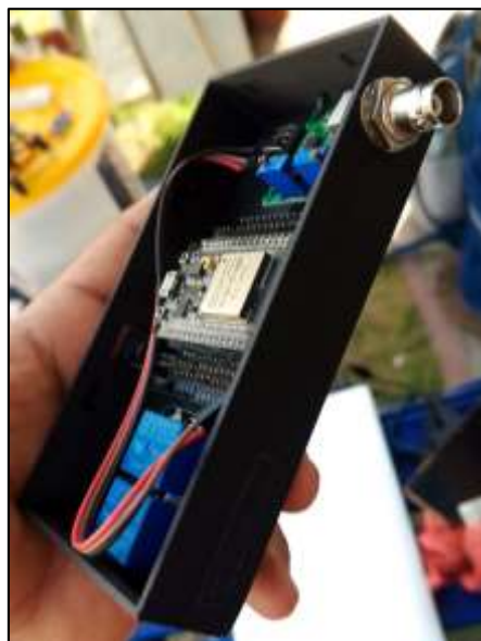
Figura 33: Colocación del módulo relé, ESP32 y módulo sensor de pH.
