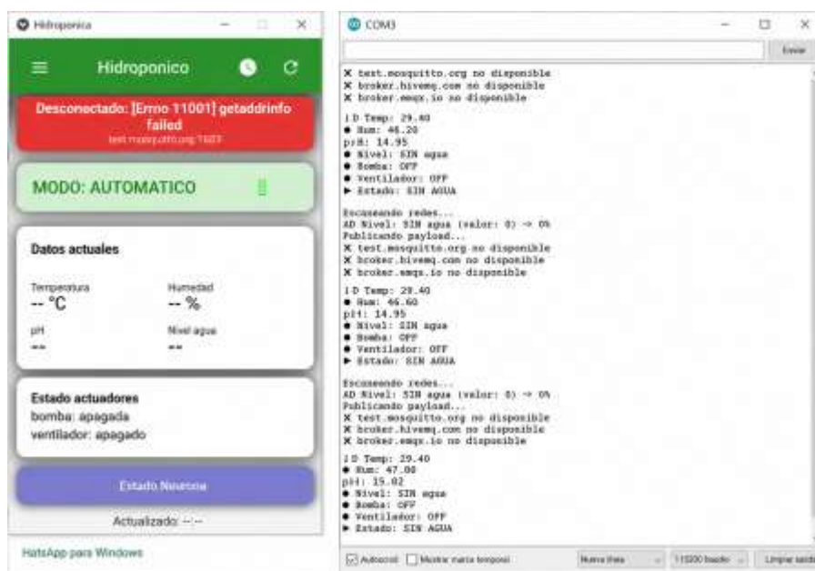
Figura 53: Evidente pérdida de la transmisión de datos debido a mala conexión de Wi-Fi
