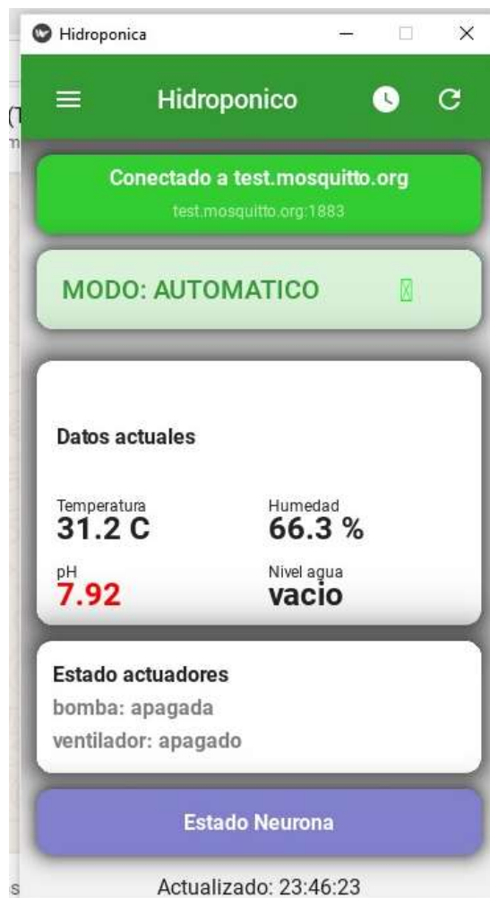
Figura 47: Control funcional ventilador apagado.
