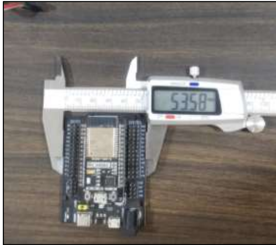
Figura 29: Uso del calibrador VERNIER para tomar medidas correctamente
