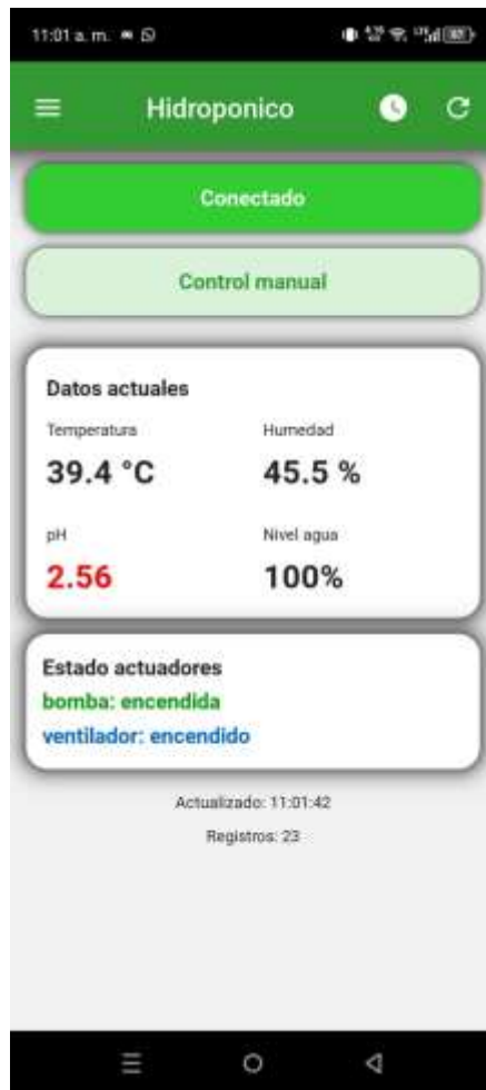
Figura 49: Activación de ventilación por temperatura elevada.
