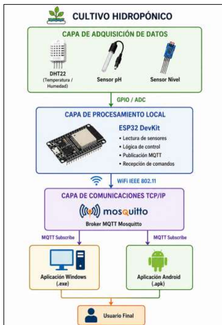
Figura 13: Arquitectura general del sistema IoT propuesto.
