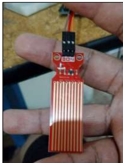
Figura 50: Sensor de nivel de agua antes de las pruebas.
