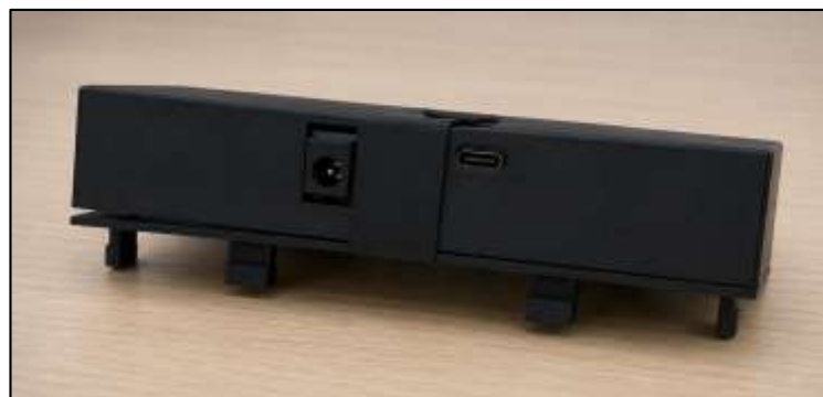
Figura 37: Vista lateral de las entradas de alimentación de energía del prototipo.
