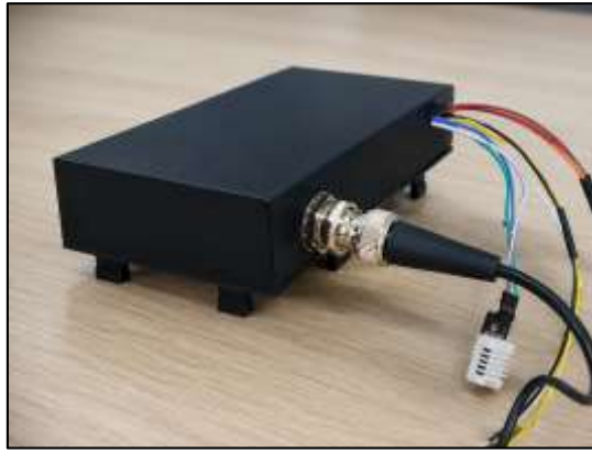
Figura 36: Encapsulado de los componentes electrónicos del sistema IoT
