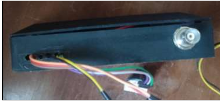
Figura 38: Vista frontal de las salidas de los sensores, actuador por cableado y por módulo de pH.
