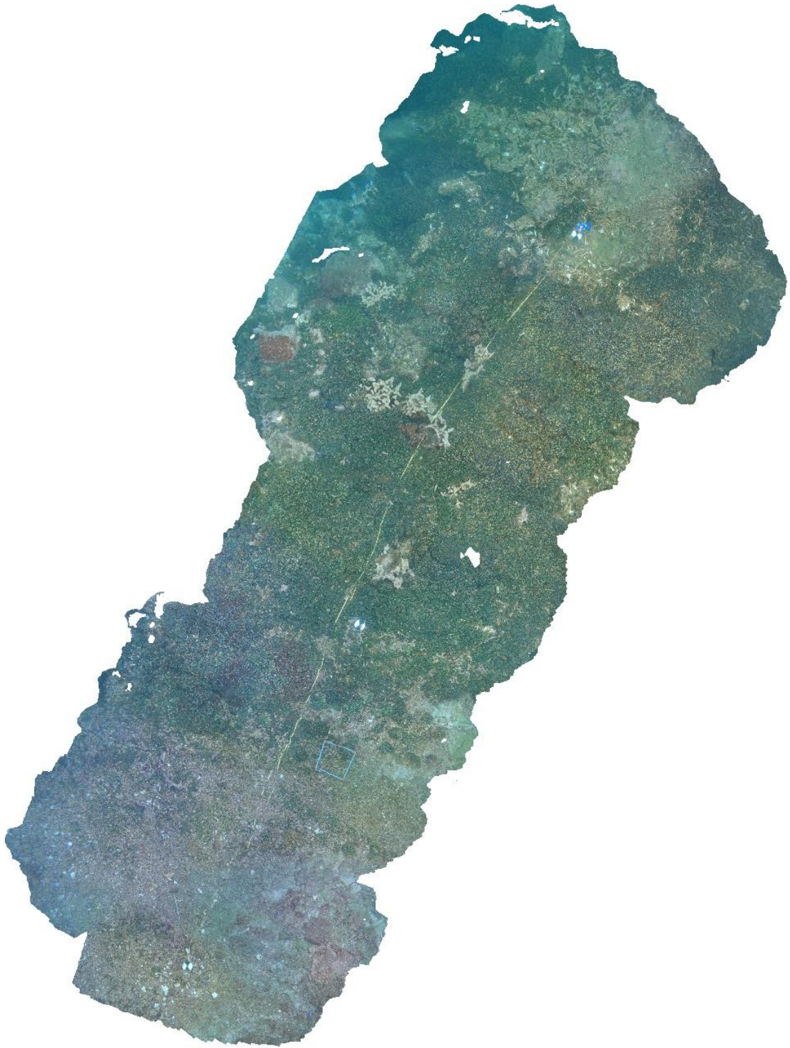
Figura 14. Ortofotomosaico del sitio El Faro, obtenido a partir de segmentación y alineación de imágenes individuales.
