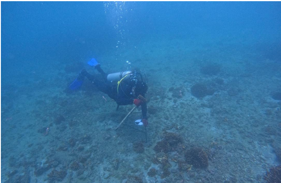
Anexo 4. Establecimiento de puntos de referencia, se puede observar el disco utilizado para ser utilizado como referencia visual sobre el punto..
