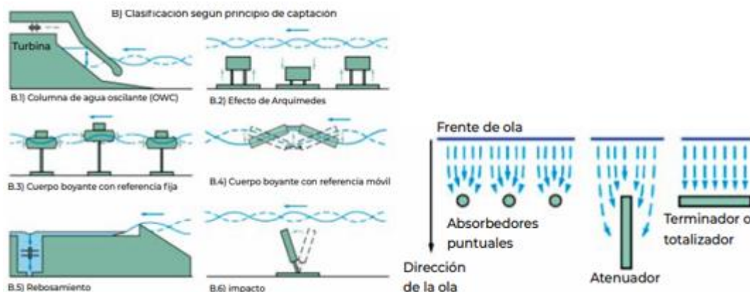
Figura 4. Clasificación dispositivos WEC acorde a su captación: tamaño y orientación
