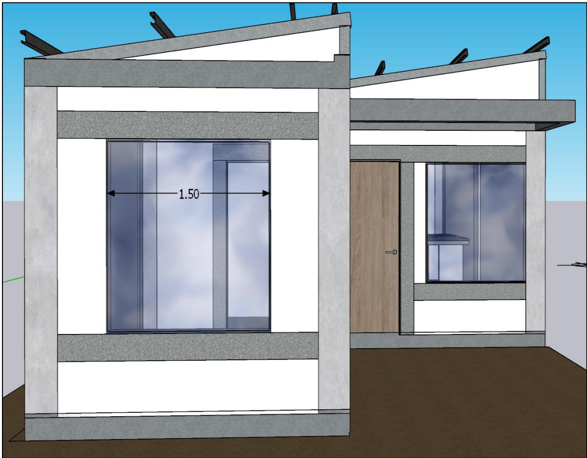
Anexo 11: Código C9 Corrección de ancho de boquetes de ventanas frontales de 1,80 a 1,50m.
