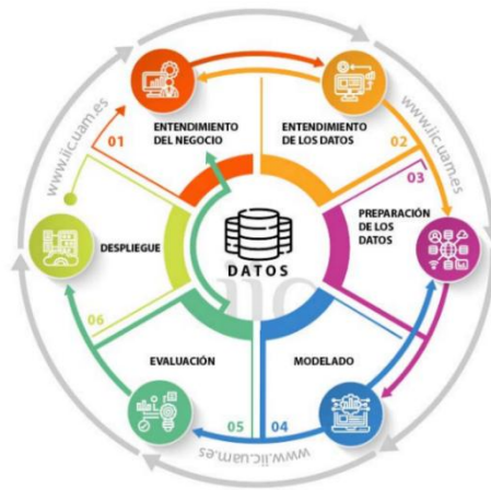
Figura 1. Esquema de las fases de la metodología CRISP-DM según [36]
