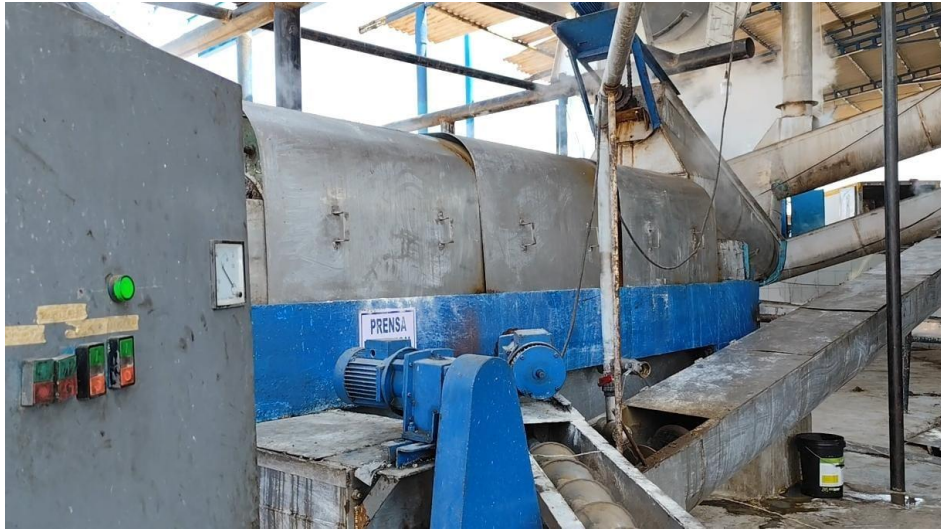
Nota: Prensa de doble husillo en funcionamiento (Amperímetro en 20 A)
