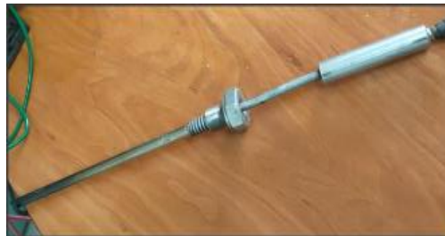
Figura 14. Termopar tipo k.
